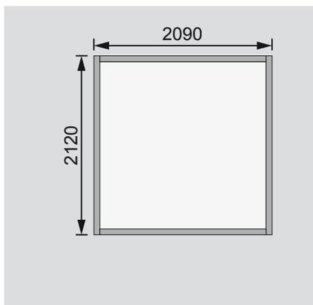
**Fundamentplan mit Boden (in mm)**
